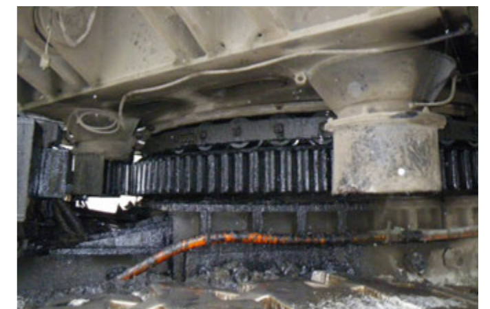
Drejegeare på en skovlhjulsgraver smurt med Berulit GA 2500
