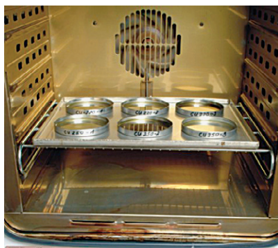
Figur 7 Ovntest af fordampningsadfærd på højtemperatur kædeolier
